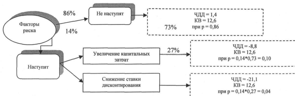
**Рис. 2. Расчет ЧДД с помощью «дерева решений»**
